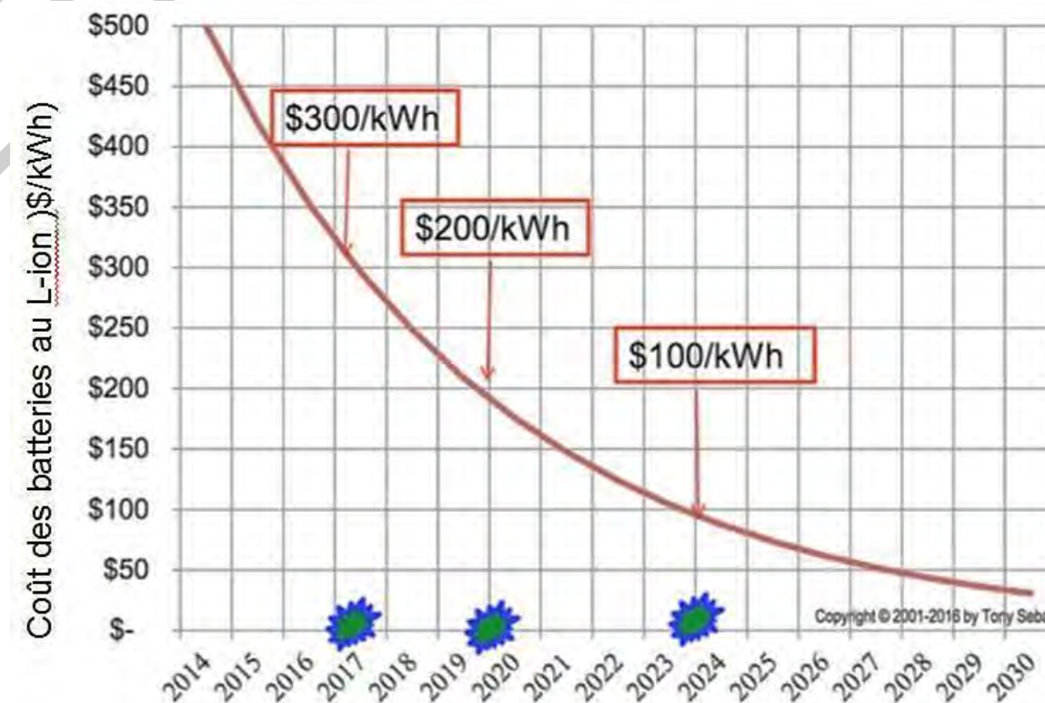
Figure 3.3 Coût des batteries au Lithium-Ion, 2010-2030 10
