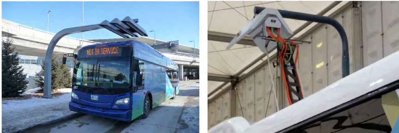
Photo 3.4 Illustration de deux types de pantographes – Fixe et mobile (ou inversé)
