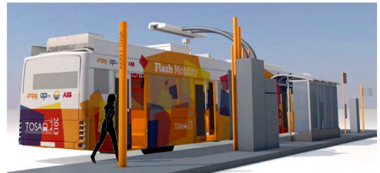
Figure 3.8 Illustration d'une station de recharge TOSA
